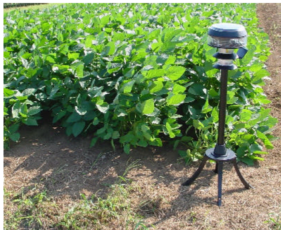
図5 圃場に設置されたフィールドサーバ(庭園灯型)
